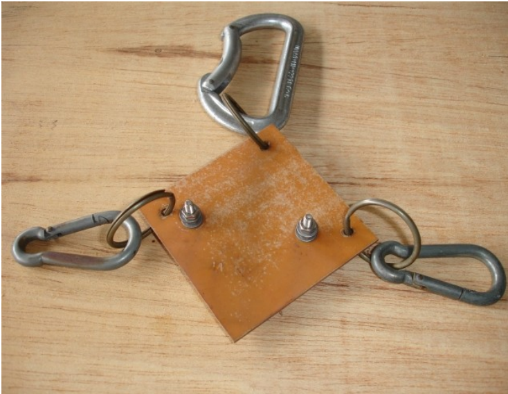
Système de suspension pour dipôle. Plaque en bakélite ou tout autre isolant.
